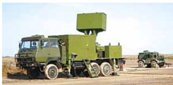
低空、超低空预警探测用 CS/RT1 型目标指示雷达
