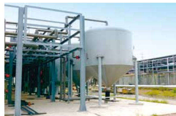
长安工业离子交换树脂系统回收重金属废水
