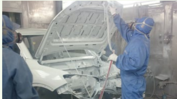
源头控制采用“水性中涂漆+水性色漆+溶剂型 2K 清漆”取代传统溶剂性漆，预计将减少挥发性有机污染物 VOCs 465 吨/年
