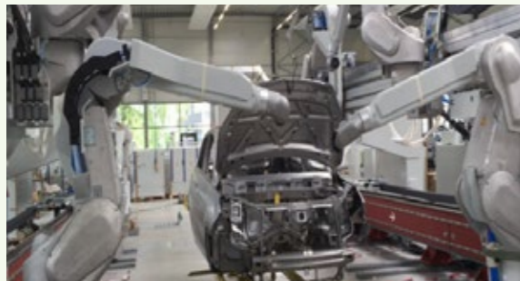
过程优化采用内口喷涂工艺优化和溶剂回收工艺优化，减少 VOCs 181 吨/年。通过对溶剂回收方式和路径进行优化，同时将溶剂回收效率提升至 80%，实现有机溶剂排放量减少 1062 吨/年
